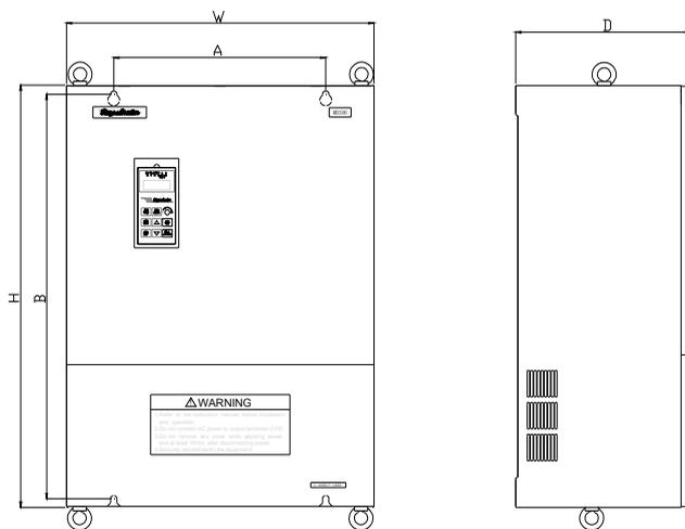
图 2-4 MD300 变频器大功率机型外形尺寸
