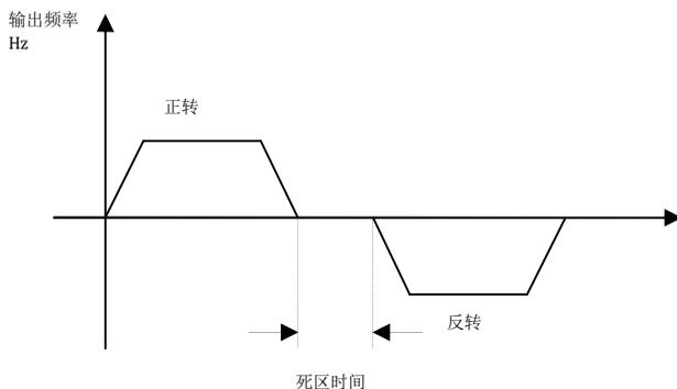
图 6-15 正反转死区时间示意图
