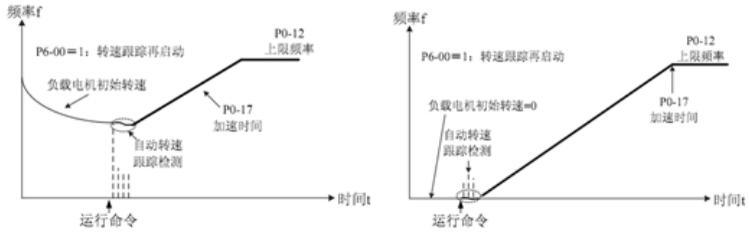
图 4-9 速度跟踪再启动方式
