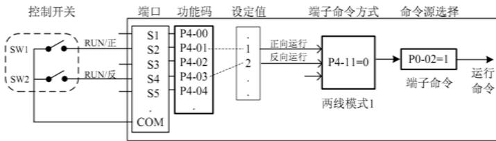
图 4-5 端子启停控制方式举例
