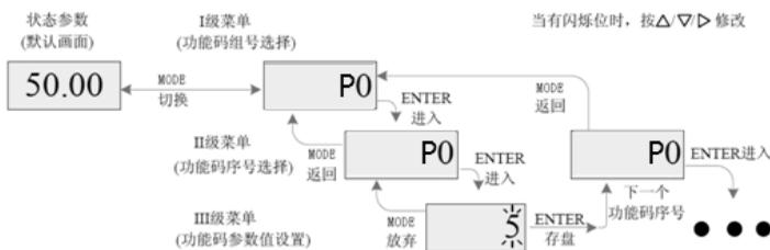
图 4-2 三级菜单操作流程图
