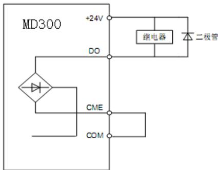
图 3-10 数字输出端子接线示意图
