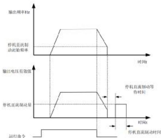
图 6-13 停机直流制动示意图
