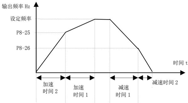
图 6-19 加减速时间切
