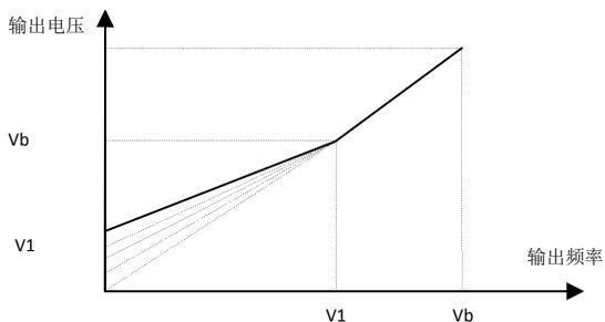
V1：手动转矩提升电压      Vb：最大输出电压
