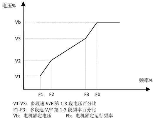
图 6-4 多点 V/F 曲线设定示意图
