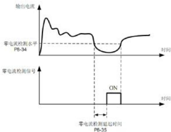
图 6-21 零电流检测示意图
