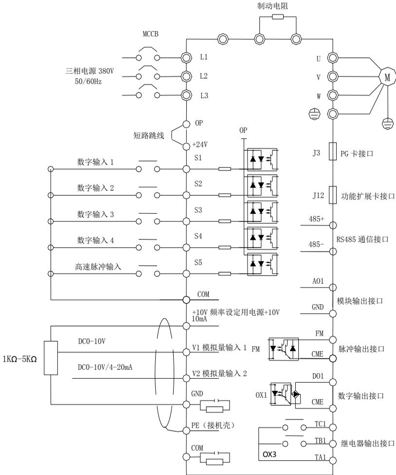
图 3-4 变频器控制回路接线方式
