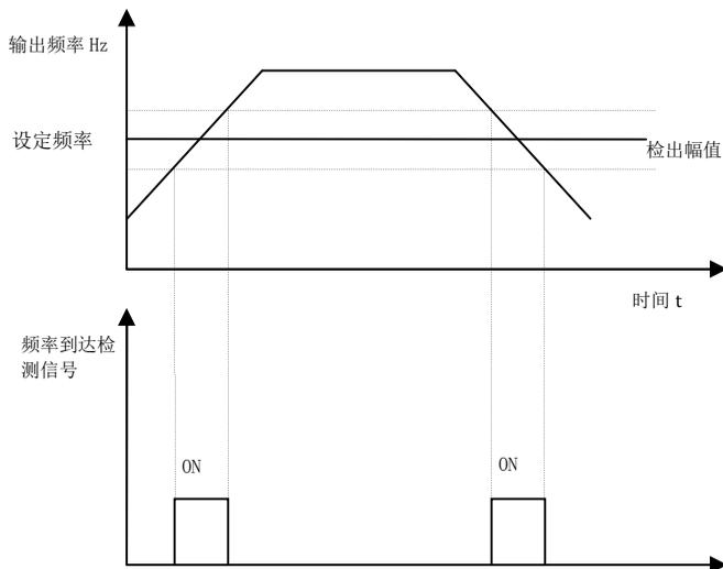
图 6-17 频率到达检出幅值示意图
