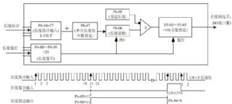
图 4-26 定长控制模式功能码设置
