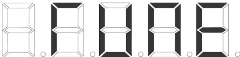
然后按键盘面板上 RUN 键，变频器会驱动电机加减速、正反转运行，运行指示灯点亮，辨识运行持续时间约 2 分钟，当上述显示信息消失，退回正常参数显示状态，表示调谐完成。经过该完整调谐，变频器会自动算出电机的下列参数：
