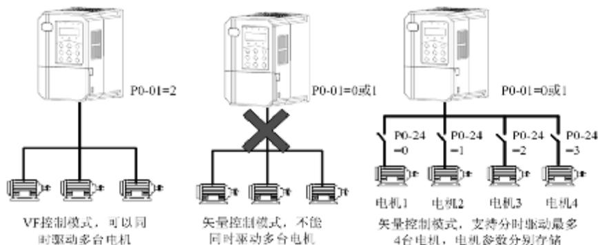
图 4-29 多组电机的切换
