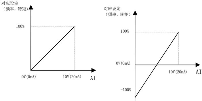
图 6-10 模拟给定与设定量的对应关系
