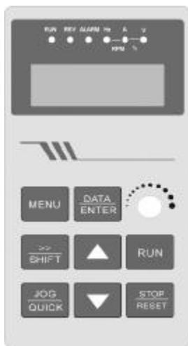
图 4-1 操作面板示意图
