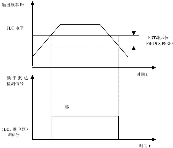
图6-16 FDT电平示意图
