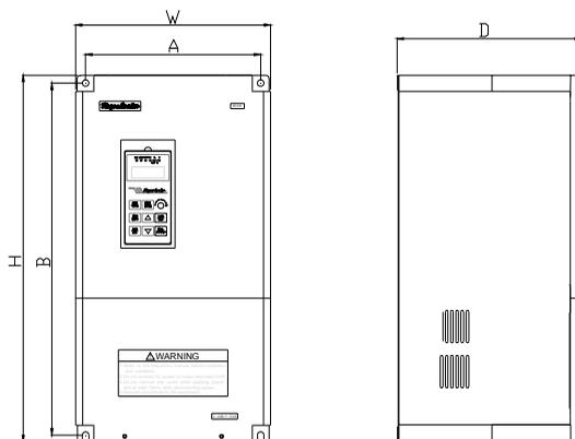
图 2-3 MD300 变频器小功率机型外形尺寸
