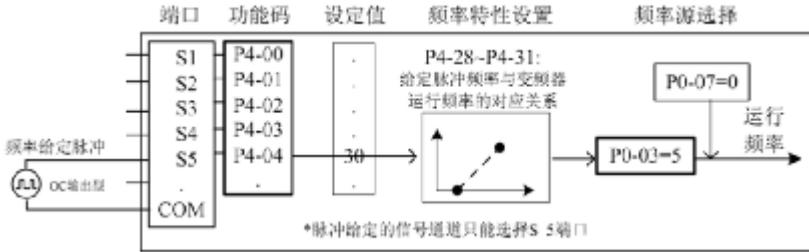
图 4-21 脉冲给定频率功能码设置
