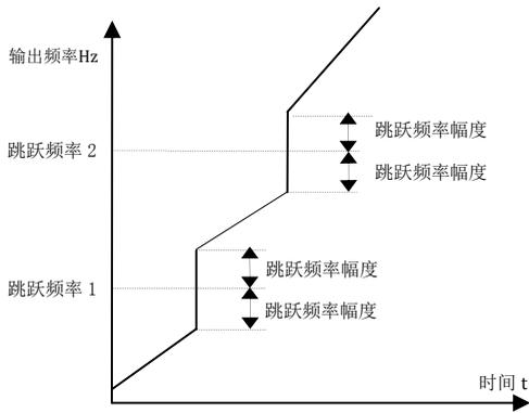
图6-18加减速过程中跳跃频率有效示意
