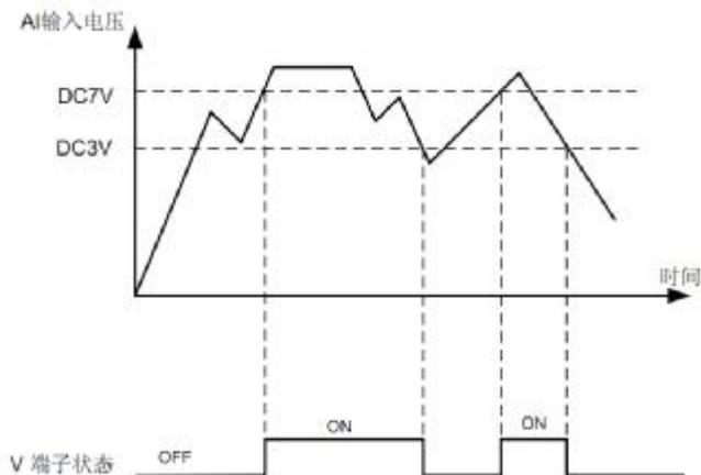
图 6-23 模拟量输入端子有效状态判断
