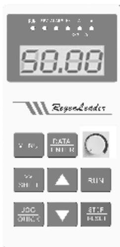
图 5.2 B 型操作面板外观布局
